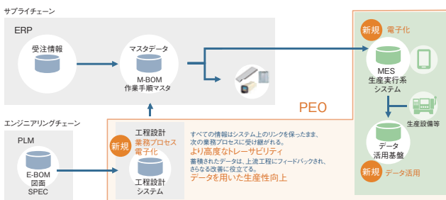
図2 統合プラットフォーム Fig.2 Integrated platform
