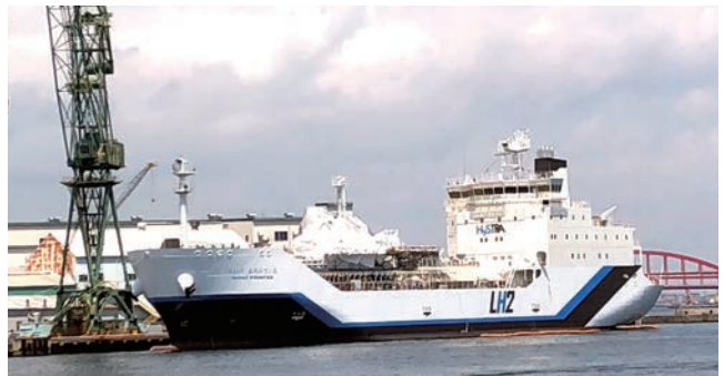
図8 艤装工事中の液化水素運搬船 (2020年5月) Fig. 8 Liquefied hydrogen carrier under outfitting (May 2020)
