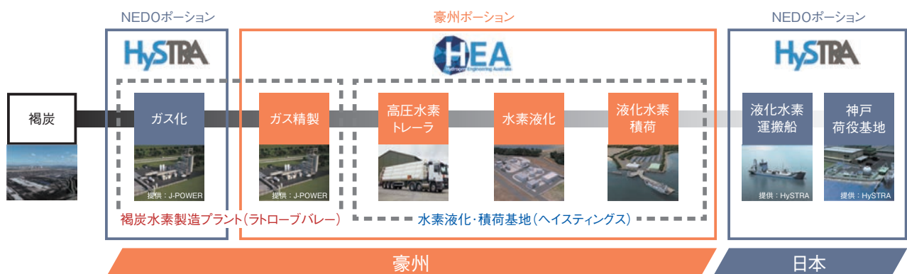
図5 日豪パイロット実証の全体構成 Fig. 5 The whole structure of Japan-Australia pilot demonstration projects
