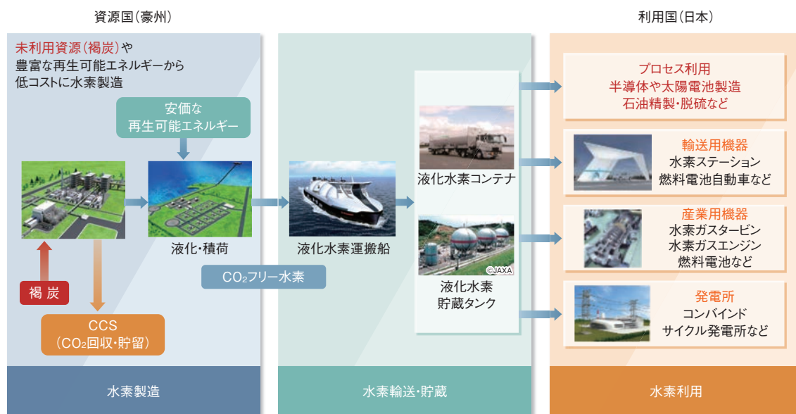
図1 CO 2 フリー水素サプライチェーン構想 Fig. 1 Concept of CO 2 -free Hydrogen Energy Supply Chains
