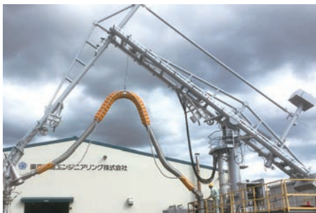
図6 実証用ローディングアームシステム Fig. 6 Loading arm systems for demonstration project
