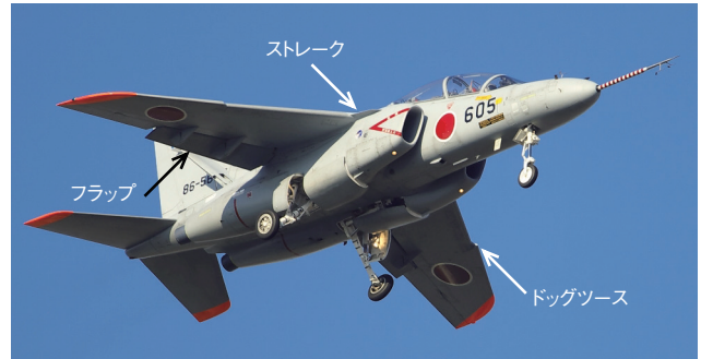
図6 航空機に用いられる空力デバイス Fig. 6 Aerodynamic devices used for aircraft
