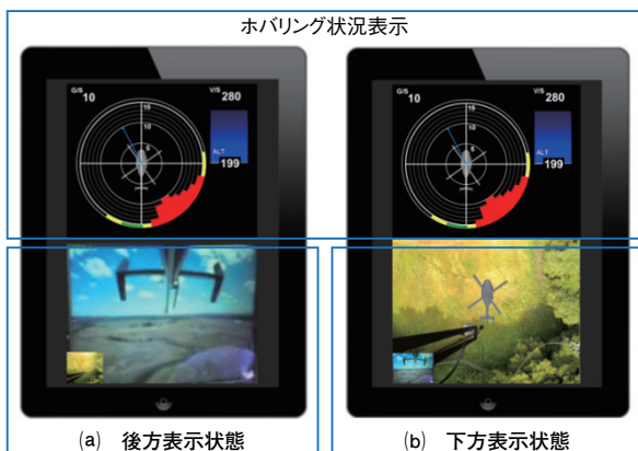
図4 専用表示装置の表示例 Fig. 4 Display example of the dedicated display unit
