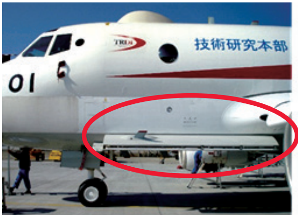
図1 内装ベイの例（「P-1」爆弾倉） Fig. 1 Example of internal weapons bay (P-1)
