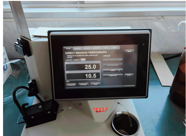
図3 定量フェログラフィー分析装置 Fig.3 Direct-reading ferrography analyzer
