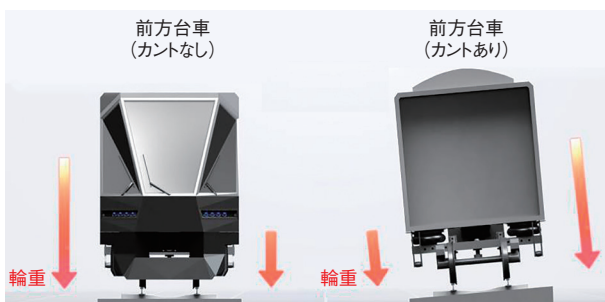
図1 軌道のねじれと輪重抜け
