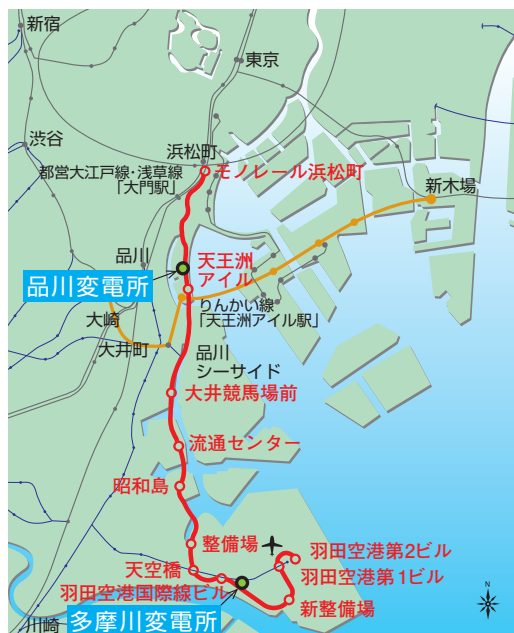
図1 東京モノレール路線図とBPS設置場所 Fig. 1 Tokyo Monorail route map and BPS installation sites
