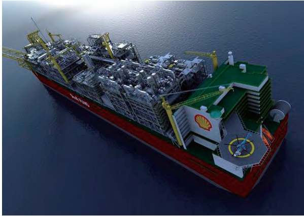
図3 シェル社 "Prelude FLNG" 220t/hボイラ7缶搭載
