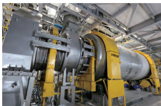
図2 炭化炉 Fig. 2 Carbonization kiln
