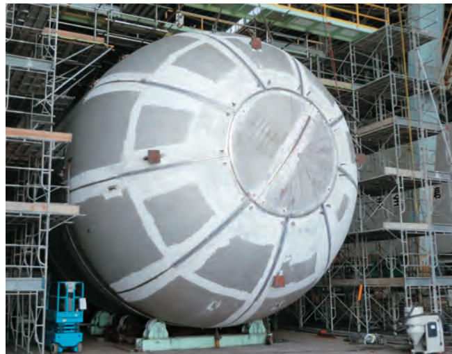
図5 試作中の陸上用LH 2 タンク Fig. 5 Trial manufacture of aboveground LH 2 tank
