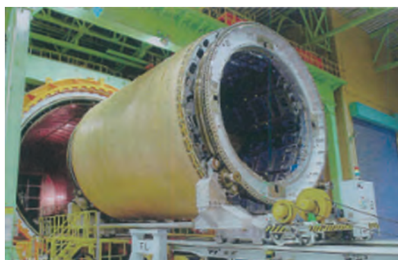
図3 オートクレーブで焼き固められた前部胴体 Fig.3 Forward fuselage cured in an autoclave
