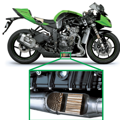
図8 モーターサイクル用浄化触媒 (ハニカム形状) Fig. 8 Three-way catalyst for motorcycle (Honeycomb form)
