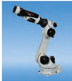
配線、配管は全て旋回部中心に配置
