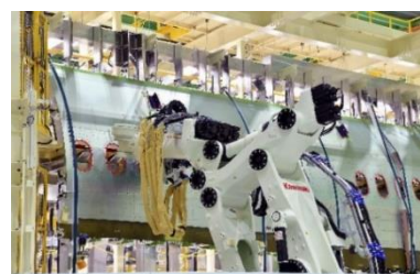
航空機製造(777-9 パネル自動穿孔)の様子(川崎重工)
