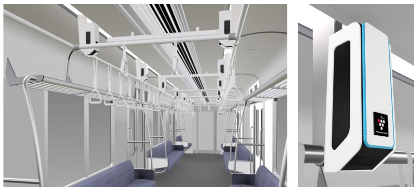
鉄道車両用プラズマクラスターイオン発生機の設置イメージ
