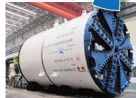
シンガポール地下鉄工事向け 泥土圧式シールド掘進機
