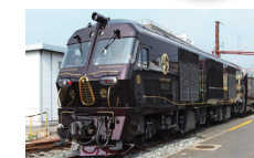
九州旅客鉄道(株)向け「なつ星in九州」用DF200形式電気式ディーゼル機関車
