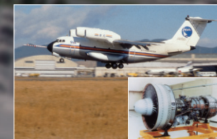
「FJR710」エンジン搭載の短距離離着陸実験機「飛鳥」
