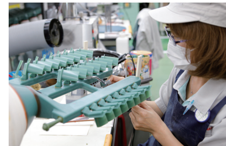
鑄造前の成形組立作業。手作業でブレードの型を取り付けます。
