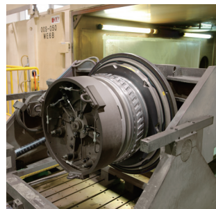
電子ビーム溶接機による溶接作業
