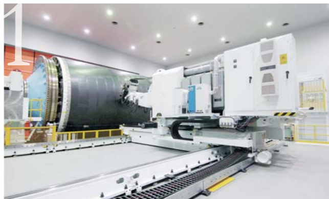
専用機械で複合材を自動積層
