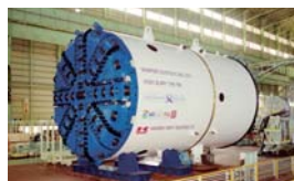
シンガポール向けφ6.63m 泥水式シールド掘進機
