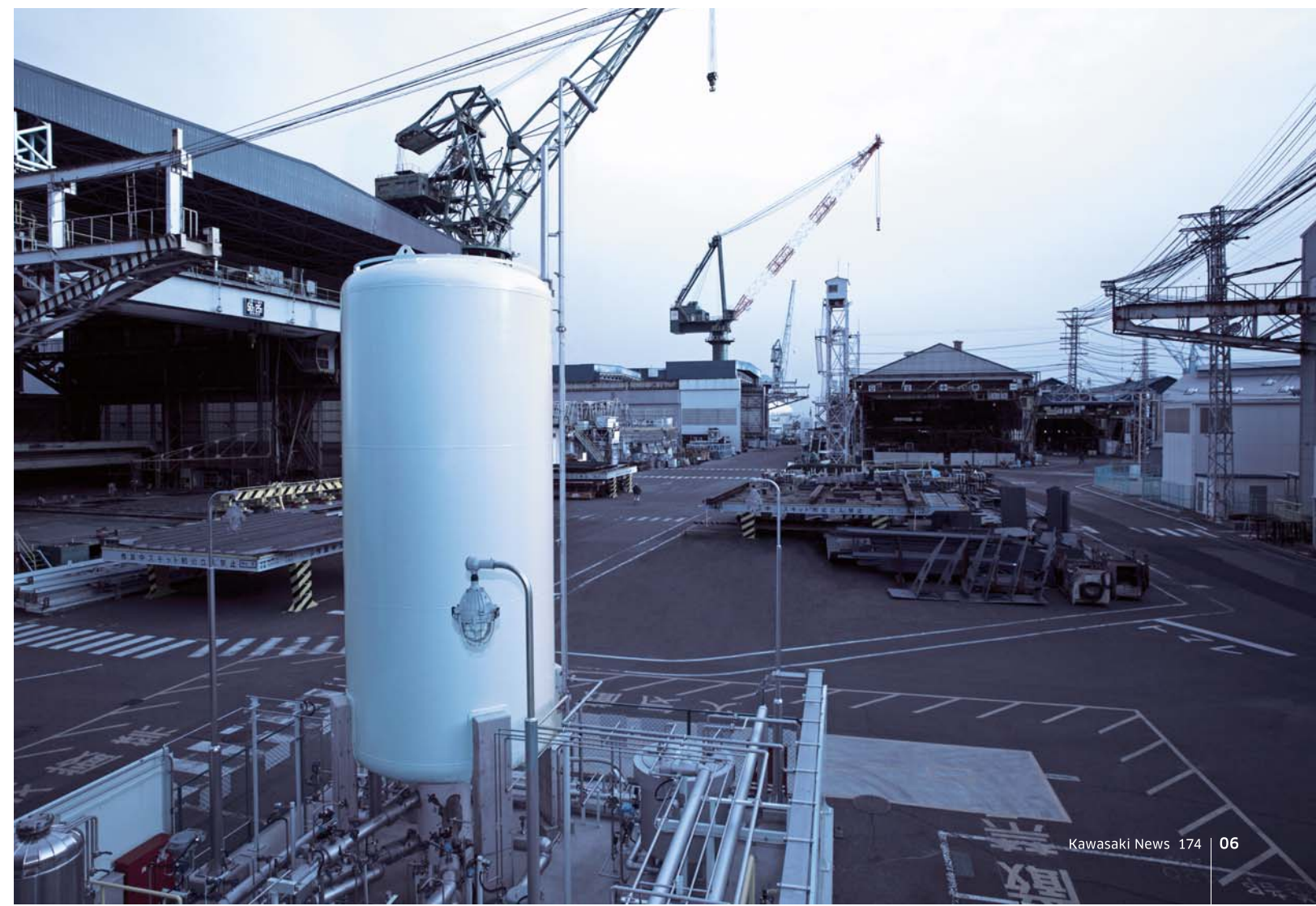
■高圧燃料ガス供給システムの概要 新しい推進システムは、LNGを燃料にするためのガス供給システムとエンジンが連動して動く。昇圧されたLNGは、高圧ベーパーライザーで温められ、安全のために二重管によってエンジンに導かれる。屋外に設置された供給システムは、造船所の一角でひととき目立つ(写真下)
