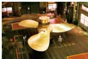
プロペラ直径11m 3翼 邦英丸 日邦汽船株式会社 銚石・石炭運搬船 11,550kW at 45min -1
