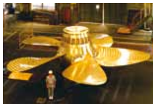
プロペラ直径9.15m 5翼 千城川丸 川崎汽船株式会社 ばら積み貨物船 12,330kW at 52.8min -1
