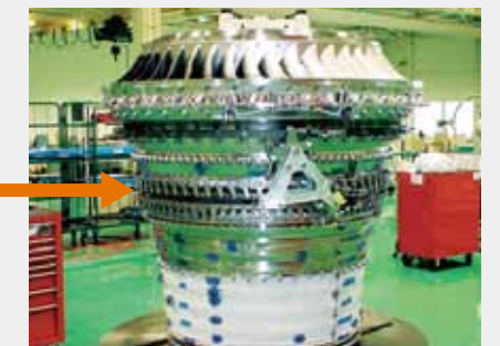
当社が設計・製作を担当している中圧圧縮機(IPC)モジュール
