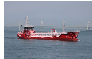
世界初のピュアバッテリー電気推進タンカー「あさひ」 (提供：旭タンカー、e5ラボ)
