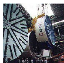
東京湾アクアライン向けシールド掘削機、掘削完了
