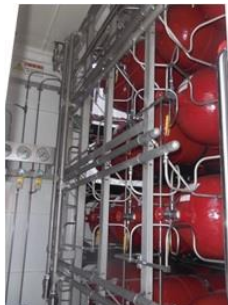
オフサイト型水素ステーションへの輸送 (日本初の複合容器搭載・圧縮水素トレーラ)
