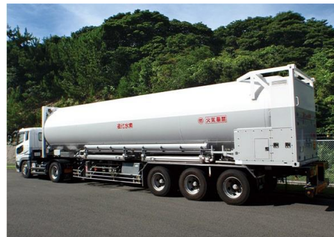
発電所などの大量消費地まで 液化水素を陸上輸送する液化水素コンテナ
