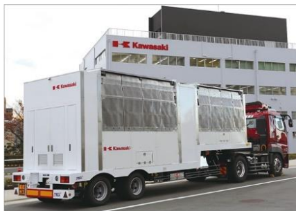
オフサイト型水素ステーションへの輸送 (日本初の複合容器搭載・圧縮水素トレーラ)
