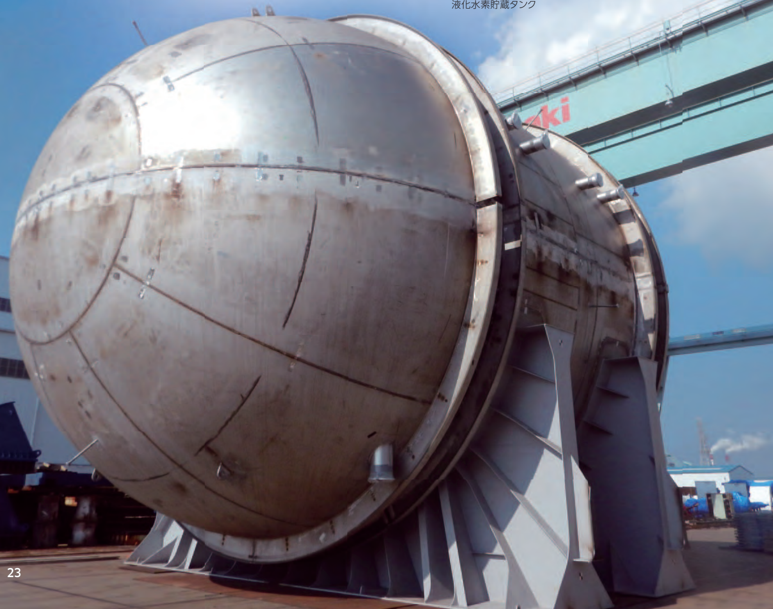
25年以上にわたり利用されているJAXA種子島宇宙センターの液化水素貯蔵タンク
