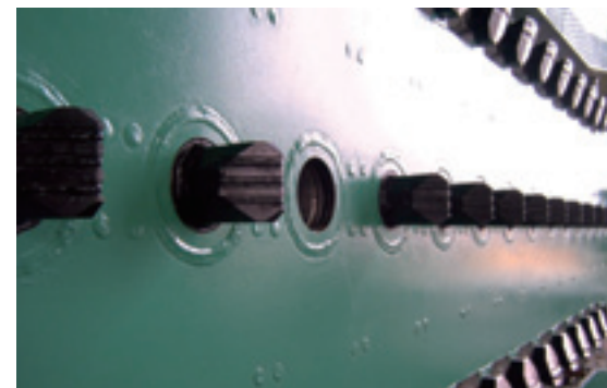
交換ビット引込状態
