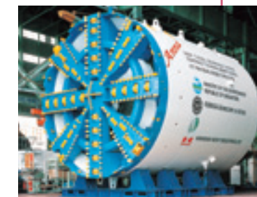
φ7.16m泥土圧シールド(DUAL MODE) (シンガポール下水道、シンガポール)
