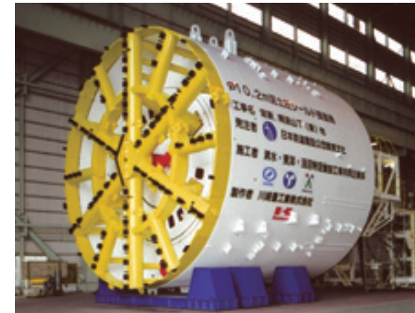
φ10.2m泥土圧シールド
