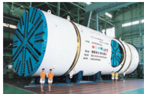
φ7.26m/φ4.24m泥水式地下茎シールド
