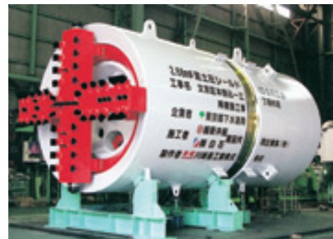
φ2.68m泥土圧シールド(DSR工法)
