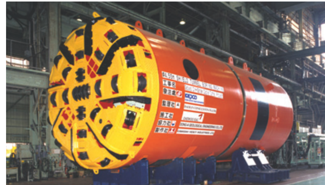
φ4.55mシールド型TBM(ベルトコンベヤ/スクリュウコンベヤ排土方式)
