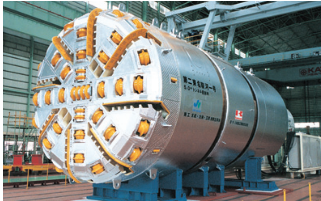
φ5mシールド型TBM(ベルトコンベヤ排土方式、R=30m対応)
