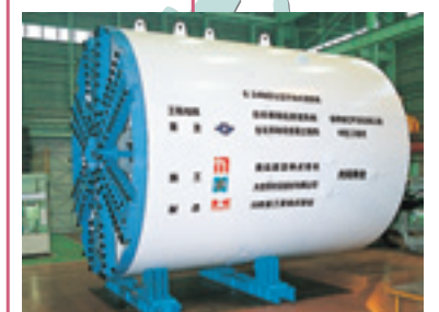
φ6.24m泥土圧シールド (台北地下鉄板橋線、台湾)
