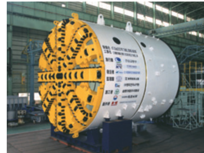
φ7.93m 泥土圧シールド
