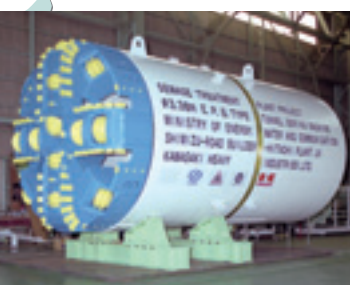
φ3.38m泥土圧シールド (マレーシア下水道、マレーシア)
