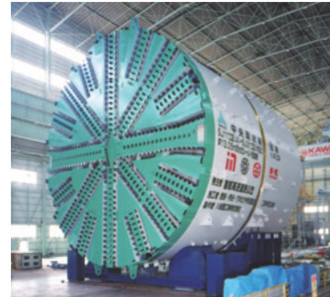
φ13.05m泥水式シールド(カッタービット交換装置装備*)
