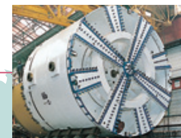
φ7.65m泥土圧シールド (リール地下鉄2号線、フランス)
