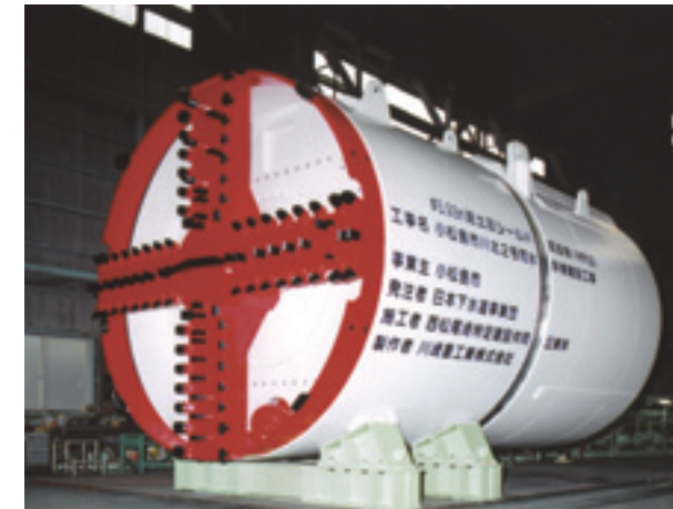
φ3.93m泥土圧シールド
