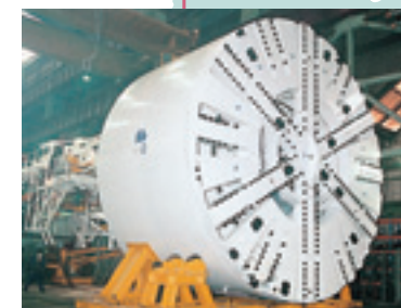
φ9.74m泥土圧シールド (リスボン地下鉄2号線、ポルトガル)
