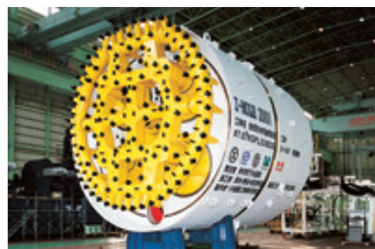
φ7.67m泥土圧DPLEXシールド
