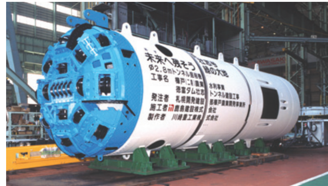
φ2.8mシールド型TBM(ベルトコンベヤ排土方式)
