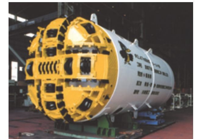
φ2.47m 岩盤泥水式シールド
