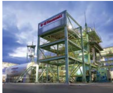
未利用資源である褐炭などから水素を製造、独自に開発した水素液化システムで水素の大量輸送を可能に
