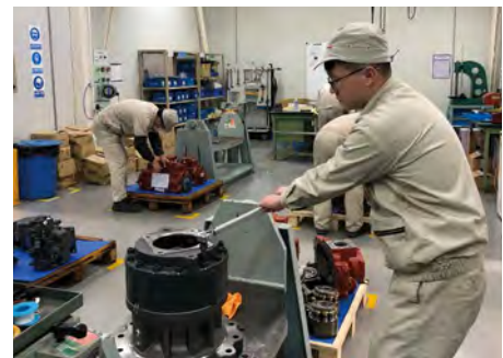
川崎精密機械商貿 (上海) 有限公司 (KPM上海) CSセンターでの油圧機器のオーバーホールなどの作業
