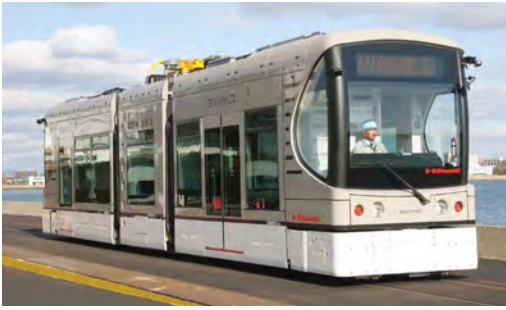
超低床電池駆動路面電車「SWIMO」
