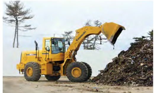
がれき処理や土地をならす作業に用いられたホイールローダ
