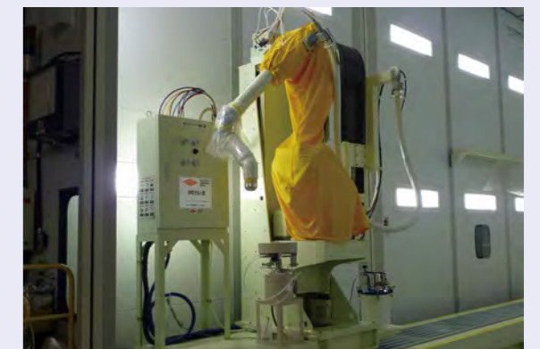
多関節式ロボットの自動塗装装置
