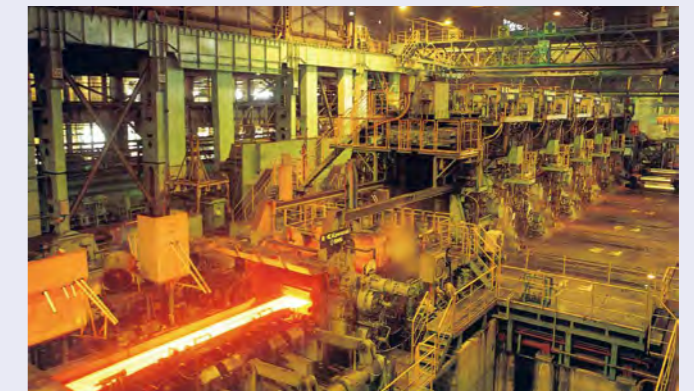
中山製鋼所船町工場の熱間圧延ライン
