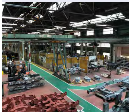
兵庫工場台車枠一貫生産ライン
