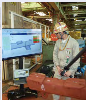
ポータブル式三次元測定器
