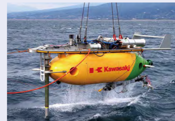
AUV海底パイプライン近接検査の実証試験に成功
