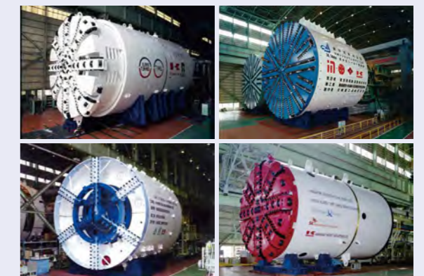
左上:英仏海峡でのトンネル掘削機、右上:東京湾アクアラインでの超大口径シールド掘削機、左下:中央環状品川線大橋での再利用型シールド機、右下:シンガポール地下鉄での泥水式シールド掘進機
