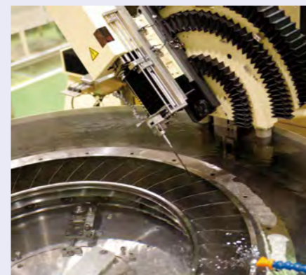
ジェットエンジン部品の高速度放電加工
