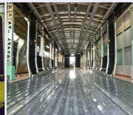
耐側面衝突性能を持つ「リング構造」
