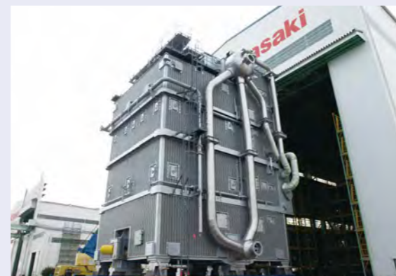
世界初のFLNG用ボイラ
