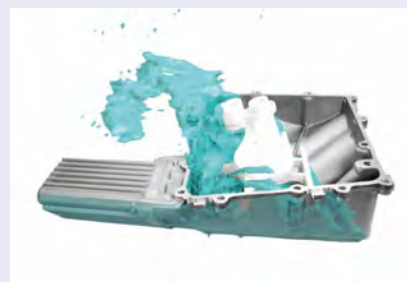
空気・油の気液二相流解析技術によるモーターサイクルオイルパン解析
