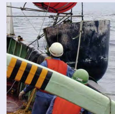
熱防護材料「アブレータ」で覆われた回収カプセル
