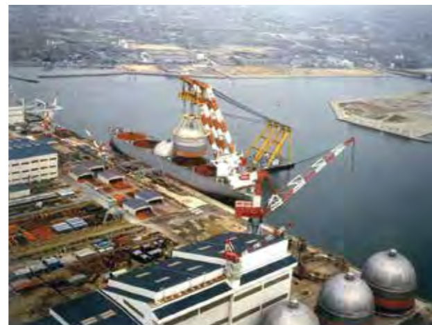
LNG運搬船「尾州丸」のタンク搭載(播磨工場・1983年引き渡し)
