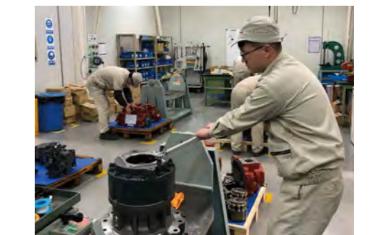
川崎精密機械商貿(上海)有限公司(KPM上海)CSセンターでの油圧機器のオーバーホールなどの作業
