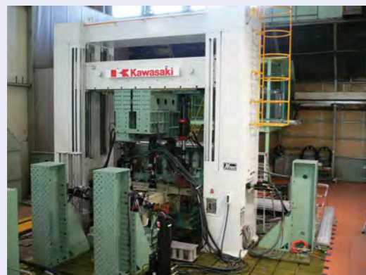
台車疲労試験装置
