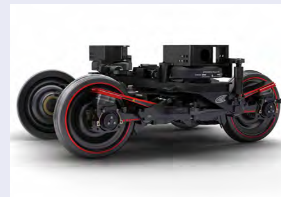
CFRPパネを採用した鉄道車両用台車「efWING」
