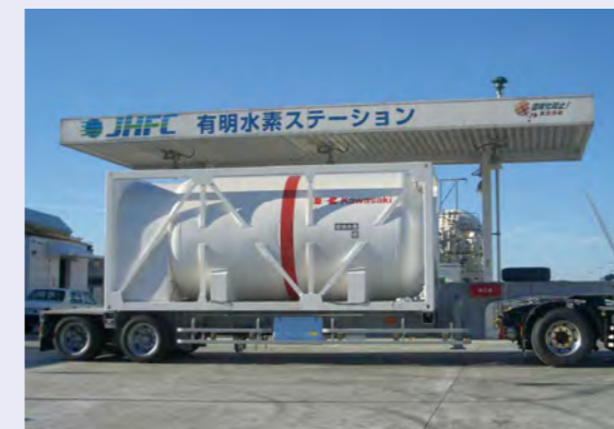
高性能液体水素コンテナを使った水素ステーションへの輸送試験
