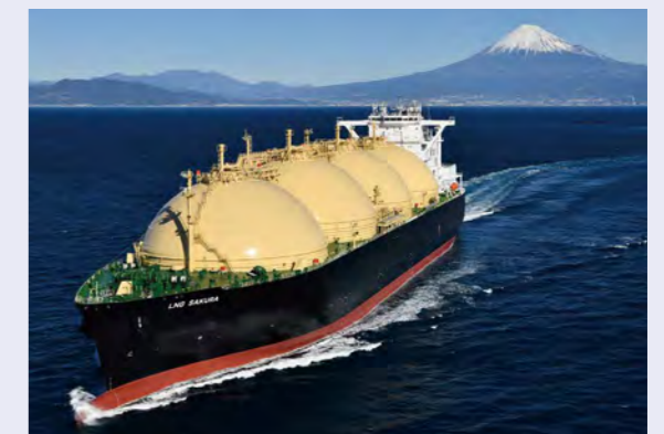
DFD電気推進システムを搭載したLNG運搬船
