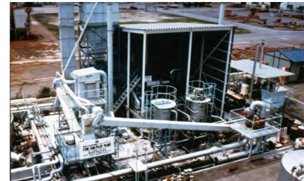
当社が製造設備とボイラの開発を担当したCOM(石炭石油混合燃料)パイロットプラント(1980年)
