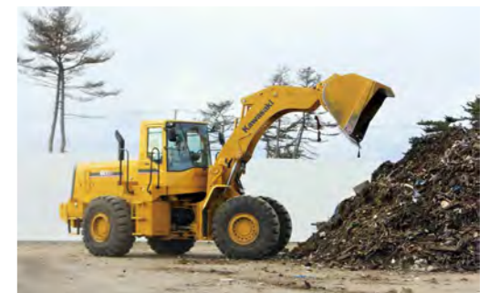
がれき処理や土地をならす作業に用いられたホイールローダ
