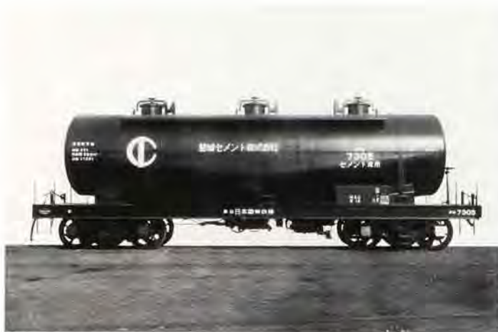
磐城セメント向けタキ7300形セメント専用タンク車——1959年納入
