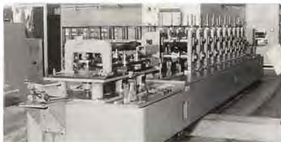
ヨーダロール成形機（多段ロール方式）
