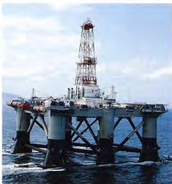
自航式半潜水型海洋石油掘削リグ（ZAPATA ARCTIC）
