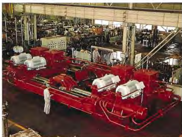
世界最大級電動油圧舵取機
