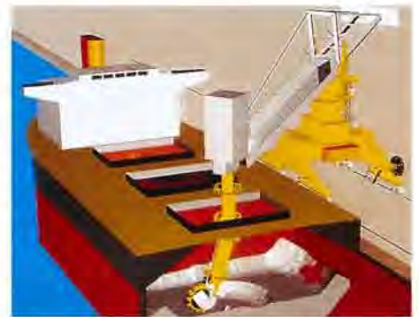
パケットホイール式連続アンローダビジュアルシミュレータ
