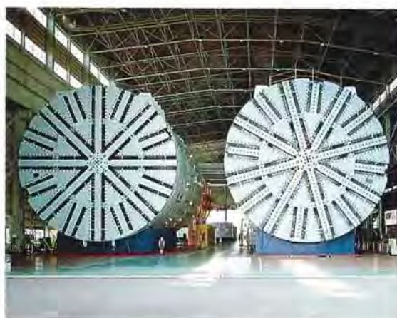
東京湾横断道路用14.14m泥水式シールド——1994年
