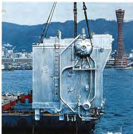
タービン船主機駆動用ボイラ（飯野海運「東邦丸」向け）—1972年
