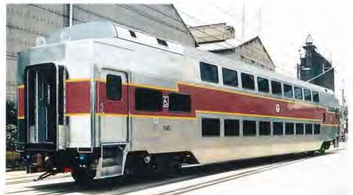
ボストン（アメリカ）MBTA向け2階建てステンレス鋼製客車——1991年納入
