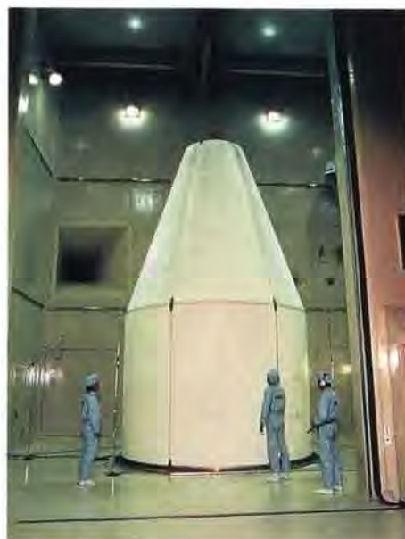
音響試験設備
