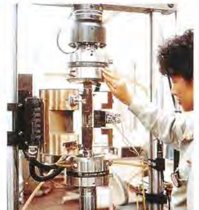
ガスタービン材の高温強度試験
