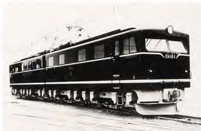
EH10形大型電気機関車——国鉄に1954年納入
