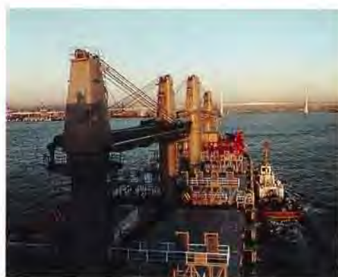
デッキクレーン
