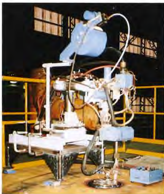
自動GTA溶接装置
