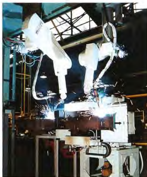
産業用ロボットを使用した電車台車部品の溶接作業（1996年）
