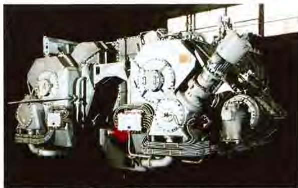
COGAG方式低雑音・防振支持型主減速歯車装置の初号機——1986年
