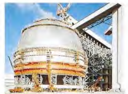
Moss型LNG運搬船用アルミニウム合金製タンク
