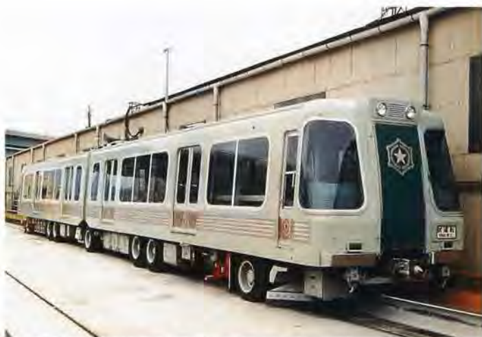
札幌市交通局向け1000形案内軌条式ゴムタイヤ電車——1970年納入
