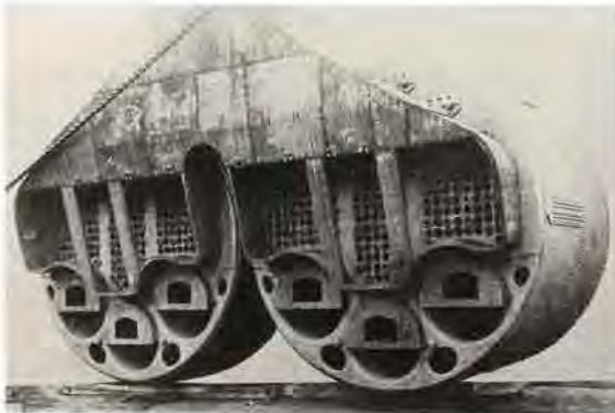
中越丸に搭載の船用ボイラ（1897年頃）
