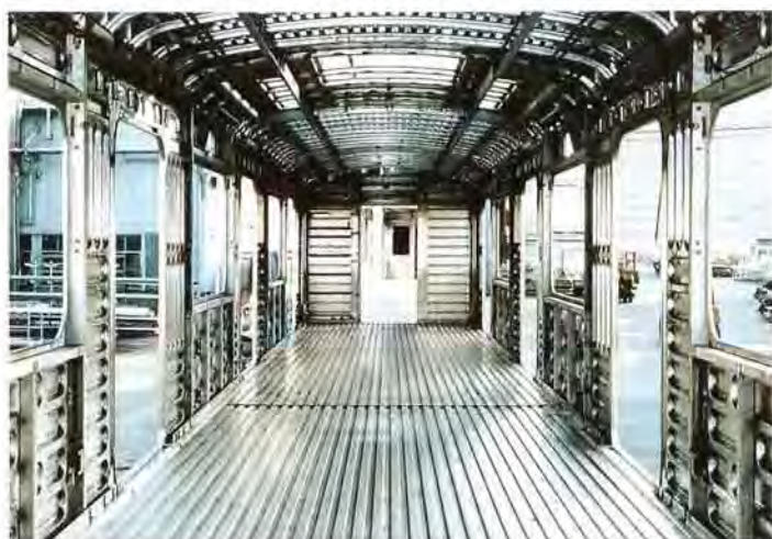
2シート工法によるステンレス鋼製構体——1992年開発
