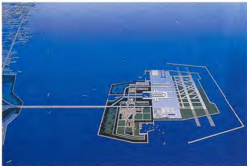
メガフロート（超大型浮体式海洋構造物）
