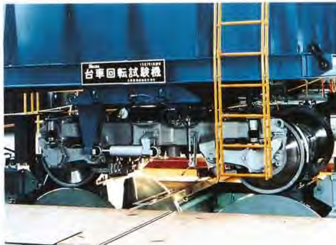
台車回転試験機——1987年新設
