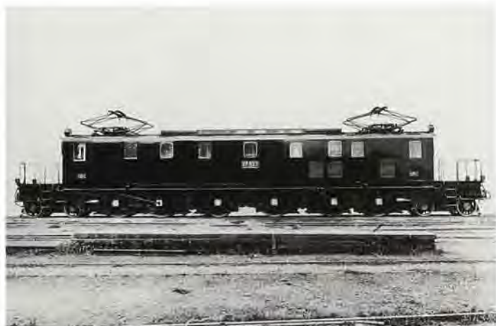
EF52形大型国産電気機関車——鉄道省に1928年納入
