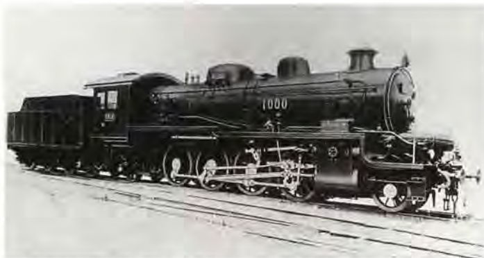
9900（後にD50）形貨物用蒸気機関車（当社製造第1000号）——鉄道省に1924年納入
