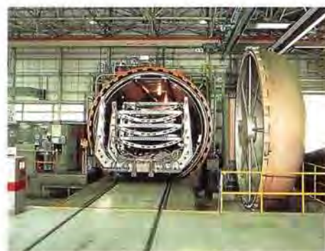
大型オートクレープ（接着・硬化用に使用される圧力釜）
