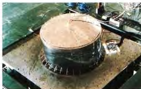
大型円筒平底タンクのスロッシング実験
