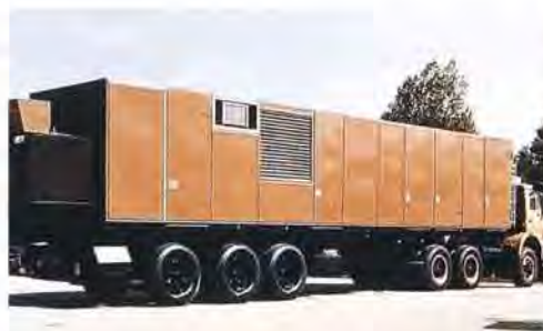
当社からガスタービンエンジンの供給を受けKHD社が開発したトレーラー形発電装置
