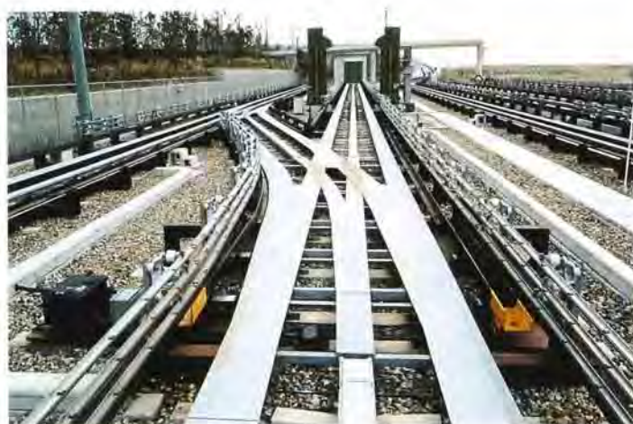
神戸新交通ポートアイランド線の浮沈式分岐器——1980年納入
