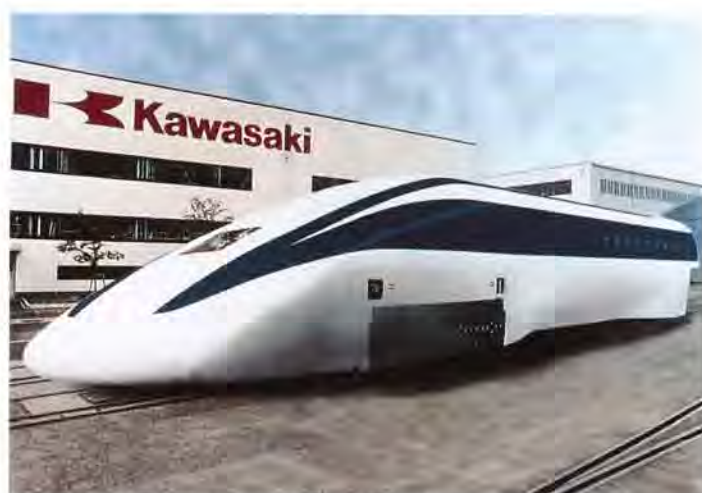
JR総研向け山梨実験線リニアモーターカー「MLX01」——1995年納入
