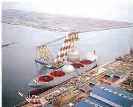
タンク搭載中のLNG運搬船「尾州丸」
