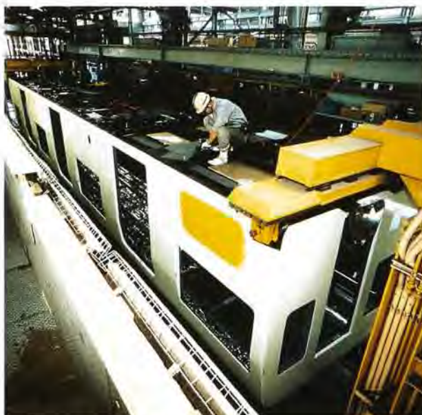
反転艀装装置を使用した電車床下艀装作業（1996年）
