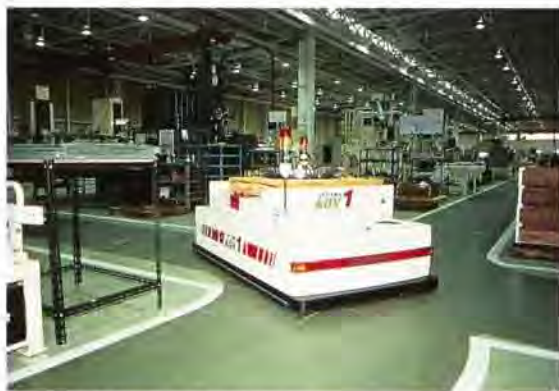
電磁誘導式AGVシステム（西神戸工場）
