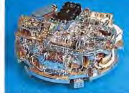
小型ロケットによる微小重力実験 用気液二相流動・伝熱実験装置
