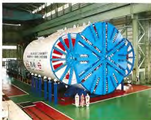
異形断面対応型トンネル掘進機（三連シールド）——1997年
