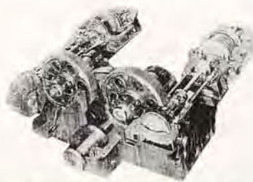
貨物船「友川丸」搭載K-16型主減速歯車装置——1948年
