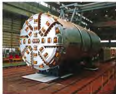
第二東名第三清水トンネル向け5.0m TBM —1996年
