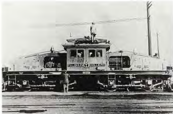
南満州鉄道・撫順炭坑用直流電気機関車——1926年納入
