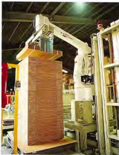
UD100によるパレタイズシステム「ダンボット」
