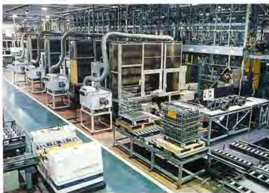
工作機械に素材を供給する無人搬送台車
