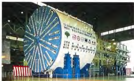
東京都神田川調節池向け13.94m泥水式シールド——1992年
