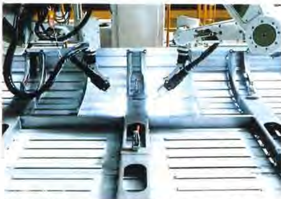
兵庫工場で稼働中の溶接ロボット（新幹線アルミ用）／生産技術開発センター
