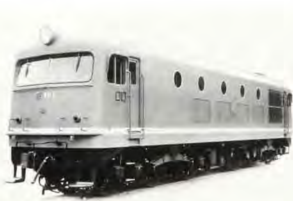
DF40形電気式ディーゼル機関車——国鉄に1956年納入
