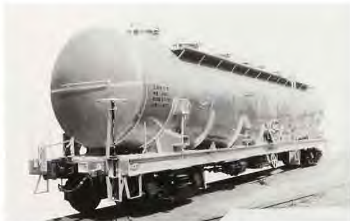
日本軽金属向けタキ8400形アルミ専用タンク車——1960年納入
