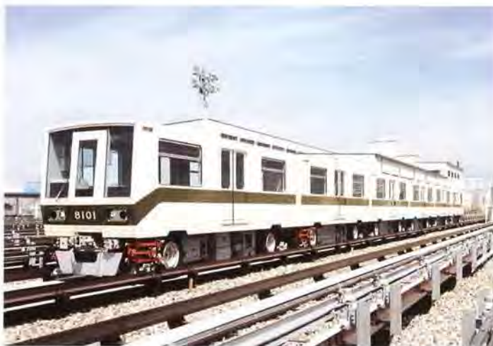
神戸新交通8000形ゴムタイヤ式新交通電車——1980年納入
