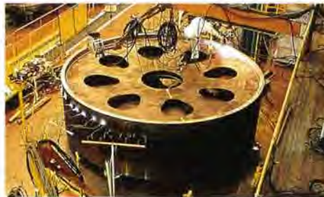
溶接中の蒸気タービン主機用歯車
