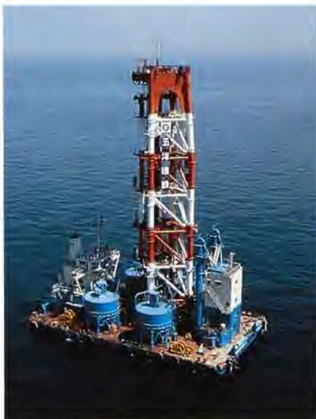
深層軟弱地盤改良作業船「ポコム2号」
