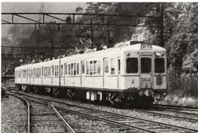
山陽電鉄2000形アルミ合金製電車——1962年納入
