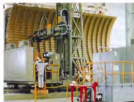
B777胴体フレームの結合（5軸NC自動打鋸機）
