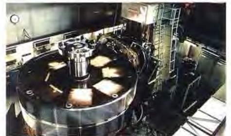
大型ホブ盤で歯切中の蒸気タービン主機用歯車
