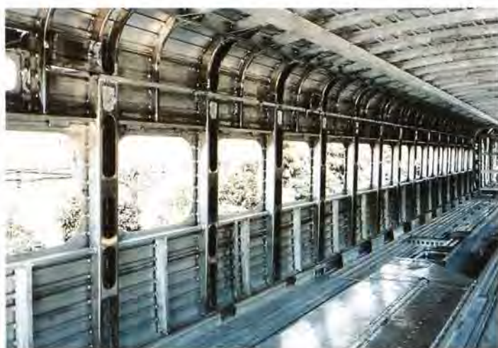
300系新幹線電車のアルミ合金製構体——1990年製造
