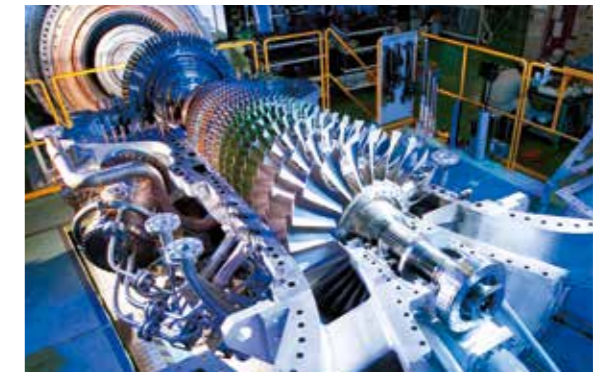
水素ガスタービン
